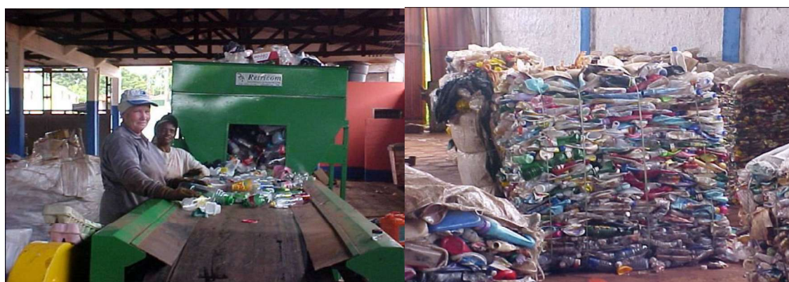
Figura 2: Prensagem do material reciclável
